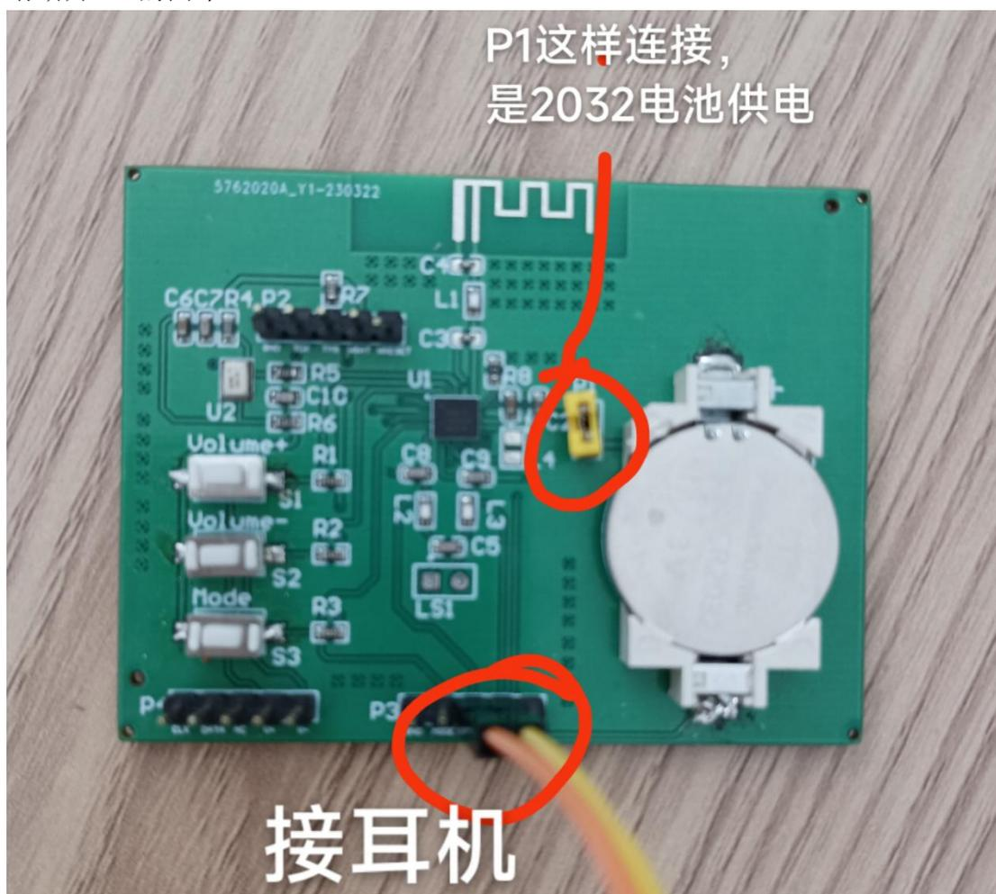
3. 我们先测试 3.5mm 的音源经过 TV Streamer 以后通过 auracast (或者称为 2.4g 私有协议) 广播到 J10 evb ,接法如下, tv streamer 上的 DIGI/Audio 开关要拨到 Audio 一侧, J10 EVB 上按 MODE 按键, 会有滴滴声, 当你听到 4 声滴滴滴, 然后听到一声轻声的滴, 就表示进入了 tv streamer 模式
